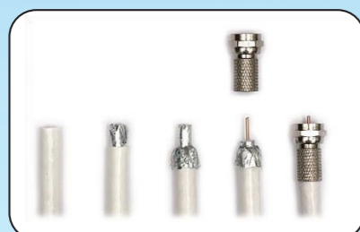
Podłączenie kabla ant. do wtyku „F”
